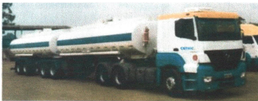
Figura 04 - Caminhão tanque e com bombeamento a vácuo
