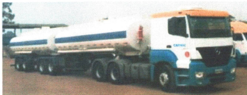
Figura 04 - Caminhão tanque e com bombeamento a vácuo
