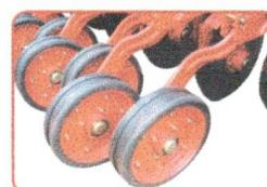
**Mecanismo de cobertura:** O mecanismo de limitação de profundidade e cobertura das sementes é através de uma única roda de borracha proporcionando uma perfeita cobertura.
